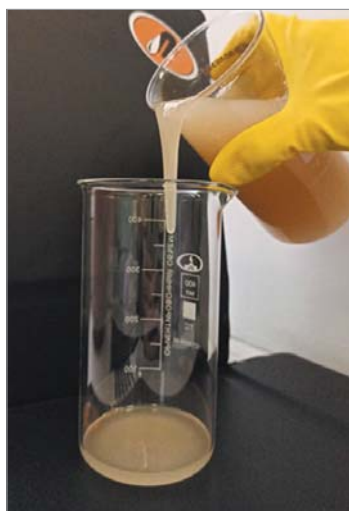
Рис. 1 Загеленная жидкость на основе БРАЙНИГЕЛЬ и солевой системы ТЖС
