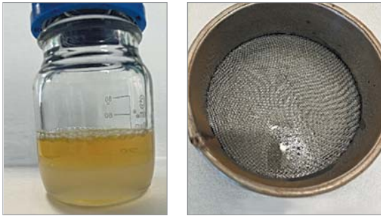
Рис. 3. Результаты тестирования на совместимость загеленной жидкости (плотность 1,84 г/см 3 ) с нефтью, T = 85 °C
