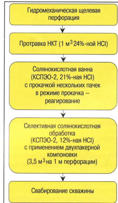
Рис. 3. Новая схема освоения скважин Мишкского месторождения
