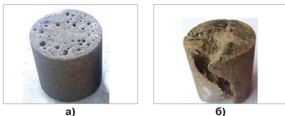
Рис. 1. Внешний вид керна после проведения моделирования СКО: а – разветвленная сеть сквозных червоточин, образованных при закачке СОКС в объеме 2,5 поровых объемов при темпе закачки 1 см 3 /мин; б – каверна и сквозная червоточина, образованные при закачке соляной кислоты в количестве 18 поровых объемов при темпе закачки 10 см 3 /мин
