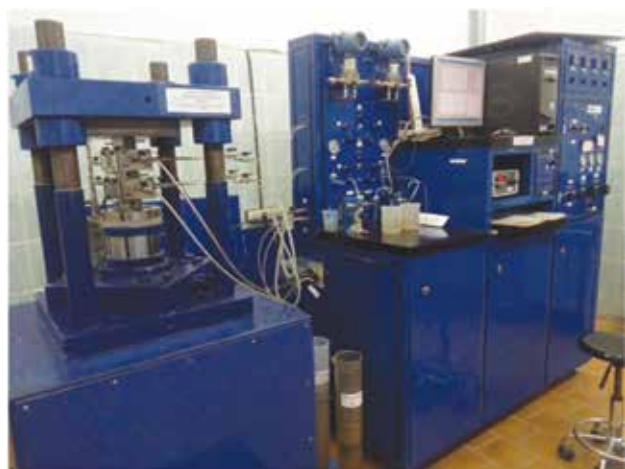
Рисунок 1 – Установка по определению проводимости и проницаемости пропантов
