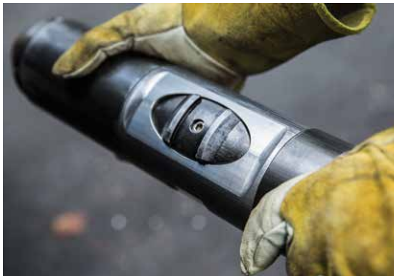
Рисунок 2 – Скважинный ключ Well Key®
